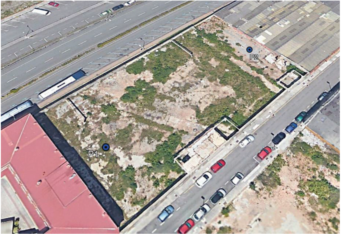
Figura 14. Localización de los piezómetros.
